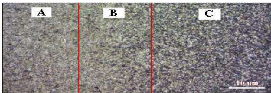
รูปที่ 13 โครงสร้างของเหล็กกล้าคาร์บอนปานกลาง AISI 1045 ที่ผ่านการอบคืนตัว ด้วยเวลาในการอัด 2 วินาทีและความดันในการอัด 2 MPa
