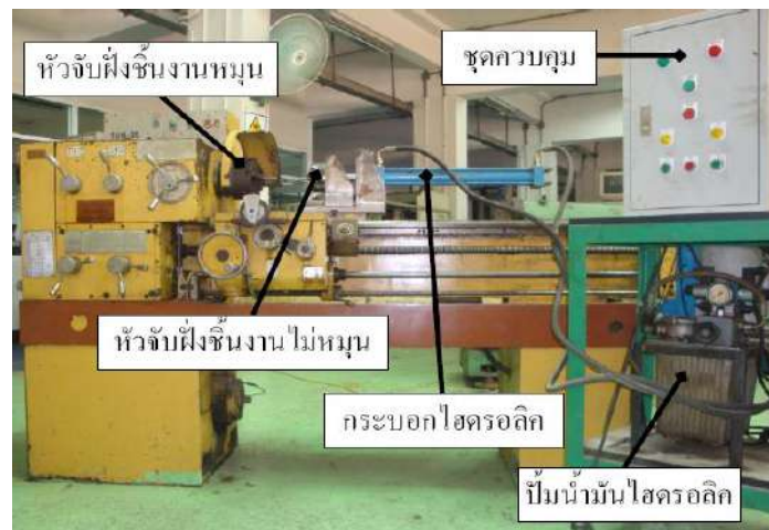
รูปที่ 4 เครื่องเชื่อมแบบแรงเสียดทาน
