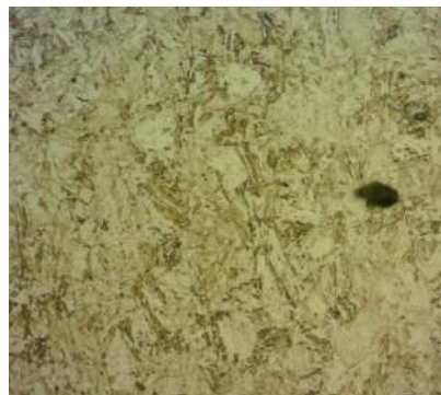
รูปที่ 10 โครงสร้างของเหล็กกล้าไร้สนิม AISI 420 ที่ผ่านการชุบผิวแข็ง โดยใช้เวลาในการอัด 9 s และความดันในการอัด 30 MPa
