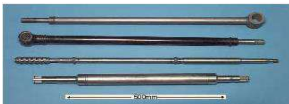
รูปที่ 1 ชิ้นส่วนรถยนต์ที่เชื่อมแบบแรงเสียดทาน
